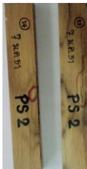
(PS 2) เจาะเข้าทำลายแค่ผิวไม้เพียง 2 ชั้น
